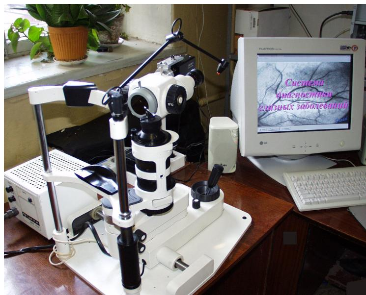
*Рис. 3. Внешний вид оптико-цифровой системы диагностики глазных заболеваний, сопряженной со стандартной щелевой лампой ЩЛ-ЗГ.*
