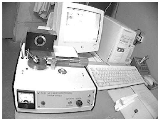
Рис.3. Общий вид прибора экспресс-контроля степени чистоты подложек.
