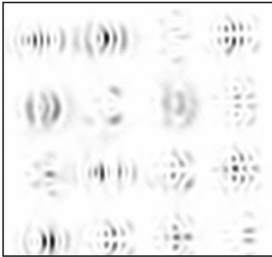
Рис. 10. Распределение интенсивности в корреляционной плоскости анализирующего модана
