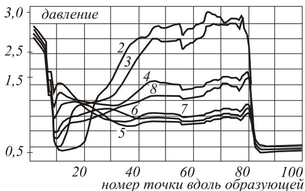
Рис.2. Пульсации давления вдоль образующей поверхности ДАО.
