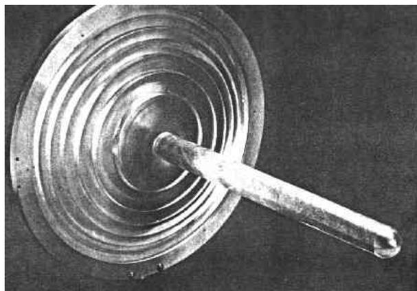
Рис.3. Внешний вид дифракционной антенны-обтекателя с аэродинамической иглой.
