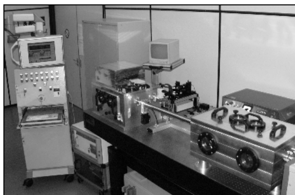
Рис. 2 Внешний вид технологической установки, использовавшейся для формирования микрорельефа на кварцевой пластине
