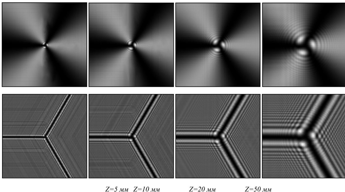
Рис. 3. Распространение линейной комбинации чистых вихрей вида  $\exp(i\theta)+\exp(-2i\theta)$ : распределение интенсивности на расстояниях  $z=5, 10, 20$  и  $50$  мм для амплитудно-фазового поля на входе (верхняя строка) и только фазового (нижняя строка).
