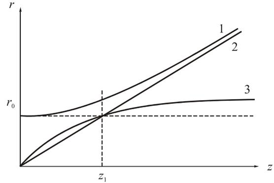
Рис. 1 Зависимость эффективного радиуса пучка от расстояния вдоль оптической оси для: гауссового пучка (кривая 1), параксиального бesselового пучка (кривая 2) и чистого вихря (кривая 3)
