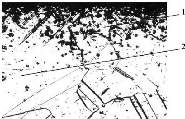
Рис. 3. Микроструктура приповерхностного слоя образца из сплава Л63 после лазерной обработки с применением фокусатора излучения и нагрева в безокислительной среде (увеличение 500): 1 – структура после обработки, 2 – исходная структура.
