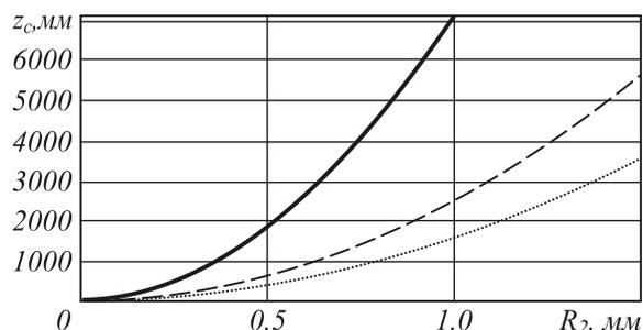
Рис. 5. Зависимость  $z_{\max}$  от радиуса апертуры  $R_2$  для ГГ-моды ( $\gamma, n$ ):  $(-5,4)$  – сплошная линия,  $(-7,4)$  – пунктирная линия,  $(-10,4)$  – точечная линия
