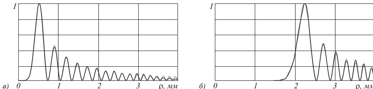
Рис. 3. Радиальное сечение интенсивности для ГГ-мод ( $\gamma, n$ ): а)  $(-10, 4)$  и б)  $(10, 4)$  на расстоянии вдоль оси распространения  $z = 1000$  мм (точечная линия – аналитическое решение, сплошная – преобразование Ханкеля)
