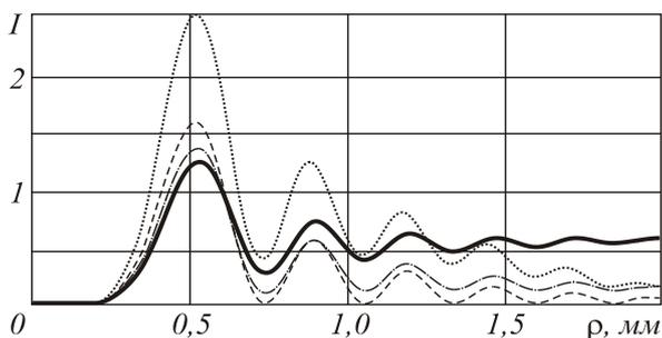
Рис. 12. Радиальное сечение интенсивности для ОГГ-пучка на расстоянии вдоль оси распространения  $z = 100$  мм для  $(\gamma, n, m)$ :  $(-10, 4, -2)$  – сплошная линия,  $(-10, 4, -1)$  – штрих-пунктирная линия,  $(-10, 4, 0)$  – пунктирная линия,  $(-10, 4, 2)$  – точечная линия
