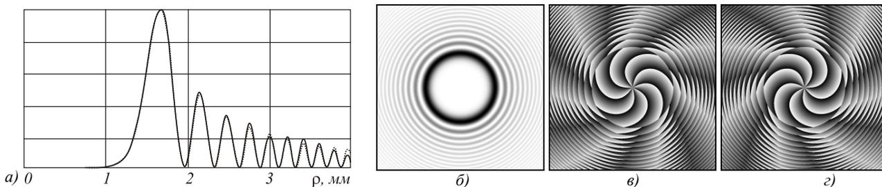
Рис. 4. ГГ-моды ( $\gamma, n$ ):  $(3, -7)$  и  $(3, 7)$  на расстоянии вдоль оси распространения  $z = 1000$  мм а) радиальное сечение интенсивности (точечная линия – аналитическое решение, сплошная – преобразование Ханкеля), б) инвертированное распределение интенсивности, в) распределение фазы для моды  $(3, -7)$ , г) распределение фазы для моды  $(3, 7)$
