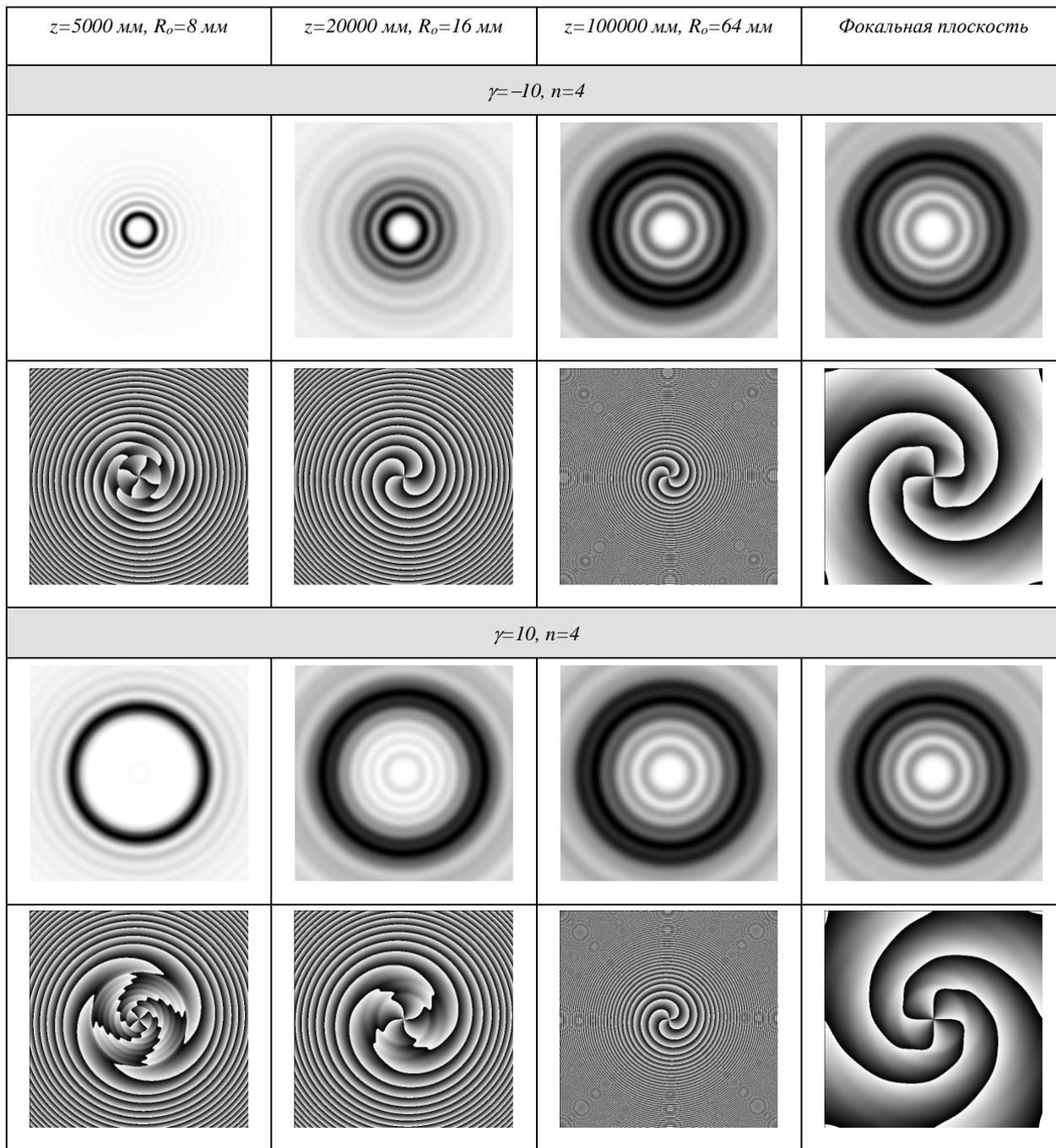
Рис. 9. Сравнение распространения ГГ-мод с противоположными знаками параметра  $\gamma$
