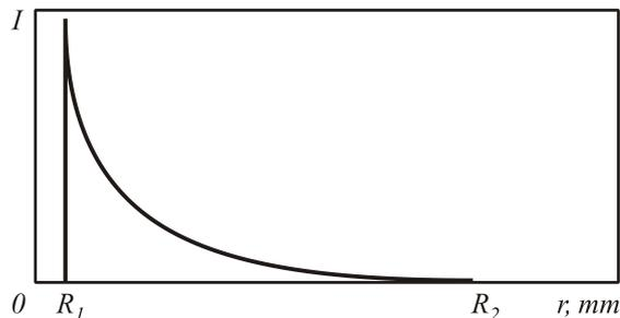
Рис. 1. Ограничение кольцевой апертурой радиального распределения интенсивности ГГ-моды во входной плоскости
