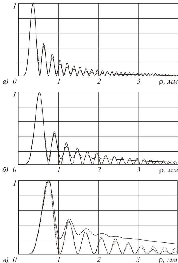
Рис. 11. Радиальное сечение интенсивности для ГГ-моды  $(\gamma, n) = (-10, 4)$  (точечная линия – аналитическое решение, пунктирная – преобразование Ханкеля) и ОГГ-пучка  $(\gamma, n, m) = (-10, 4, -1)$  (сплошная линия) на расстоянии вдоль оси распространения  $z = 500$  мм (а),  $z = 1000$  мм (б),  $z = 2000$  мм (в)
