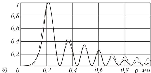
Рис. 2. Радиальное распределение интенсивности ГГ-моды ( $\gamma, n$ ):  $(-10, 4)$  при  $z = 100$  мм (а) и  $z = 200$  мм (б): аналитический вид ГГ-моды (точечная кривая) и рассчитанный после ограничения апертурой (сплошная кривая)
