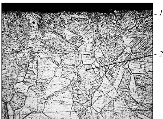
Рис. 4. Микроструктура приповерхностного слоя образца из сплава Л63 после лазерного воздействия (увеличение \times 1000 ): 1 – нанопористый слой; 2 – исходная структура
