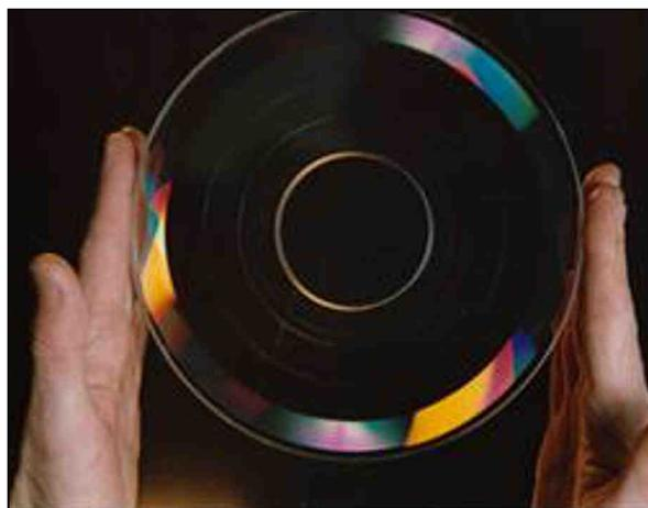
Рис. 5. Фотография радиального голографического диска со средним диаметром штриховой дорожки:  $\varnothing=180$  мм и числом штрихов  $N=518400$
