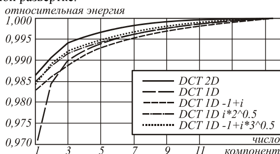
Рис. 3. Сравнение эффективности двумерного ДКП (размер блока 4 \times 4 ) и одномерных ДКП (размер блока 16) на различных развёртках
