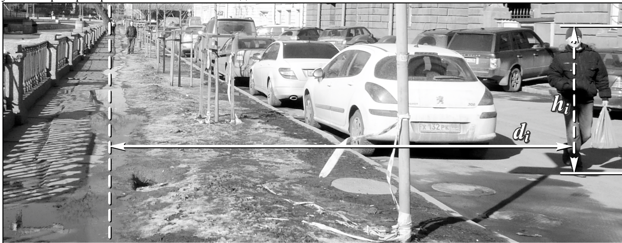
Рис. 1. Размеры высоты изображения объекта и поперечного отклонения от оси телекамеры
