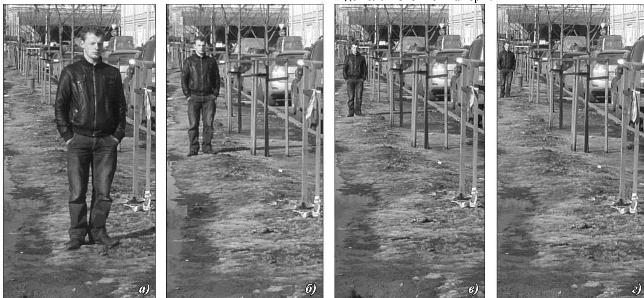
Рис. 6. Поэтапное увеличение дистанции до объекта от положения телевизионной камеры: на 10 м (а), 20 м (б), 30 м (в), 40 м (г), соответственно
