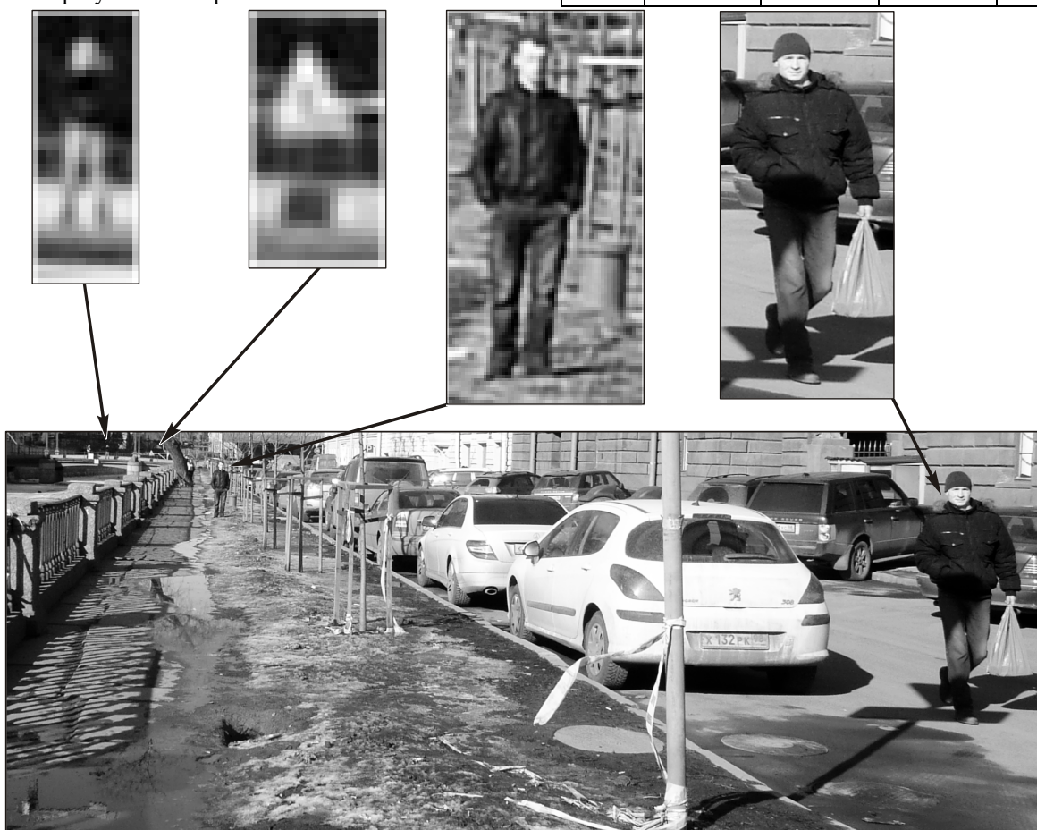
Рис. 8. Вид экрана телевизионной камеры и фрагменты изображения, расположенные на разном удалении от телекамеры
