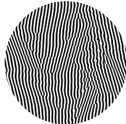
Рис. 5. Фазовая функция ДОЭ, формирующего распределение «полумесяц»
