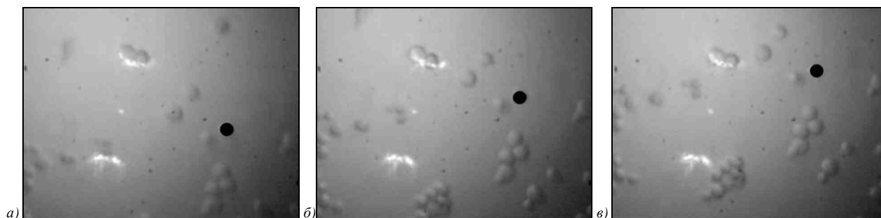
Рис. 11. Захват клеток дрожжей пучком-полумесяцем. Чёрная точка отмечает положение неподвижной относительно предметного столика клетки. Белая стрелка – положение захваченной частицы. Промежуток времени \tau между снимками – 0,55 с
