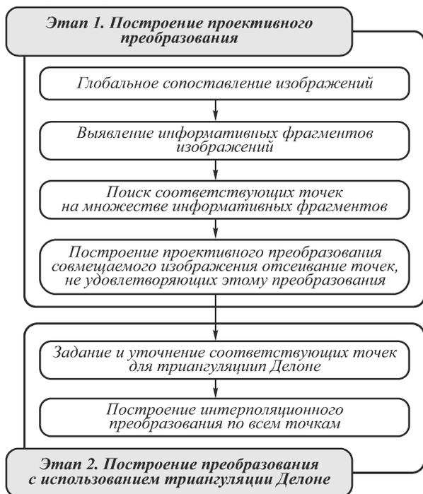
Рис. 1. Схема этапов построения преобразования для совмещения изображений
