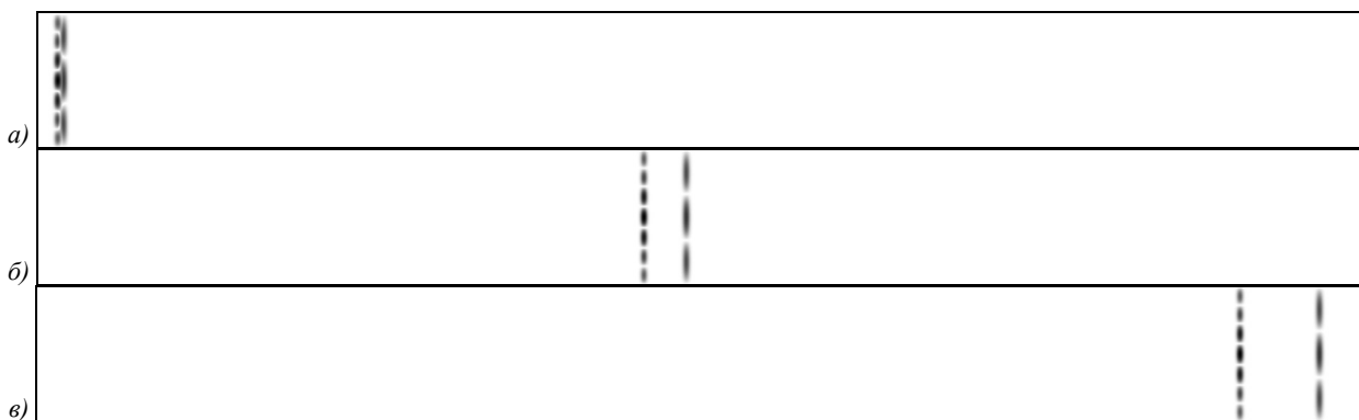
Рис. 4. Распространение суперпозиции двух мод в волноводе длиной 18 мм, распределение амплитуды (негатив) в различные моменты времени: а) t = 5 нс, б) t = 30 нс, в) t = 60 нс
