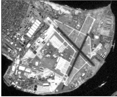
Рис. 8. Монохромное изображение аэропорта в г. Сан-Диего (США), сформированное математической моделью космического гиперспектрометра в канале, соответствующем длине волны \lambda \sim 555 нм
