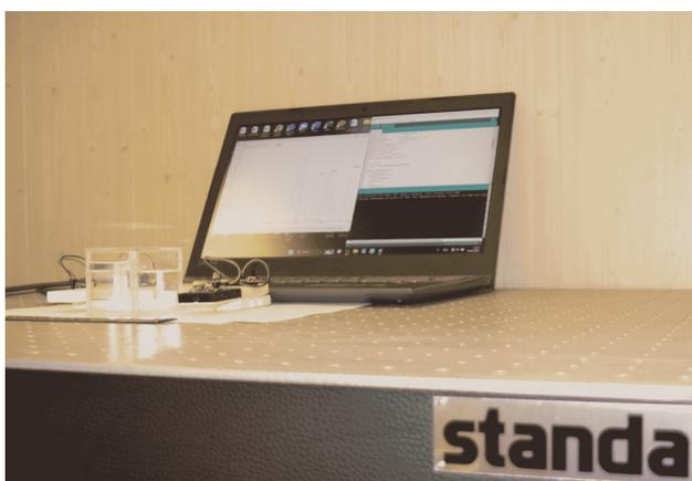
Рис. 7. Фото дифференциального рефрактометра
