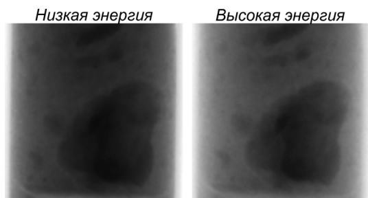
Рис. 5. Рентгеновские изображения сростка берилла с мусковитом, помещенные в цилиндр с измельченным мусковитом. Изображения получены при разном спектральном составе излучения
