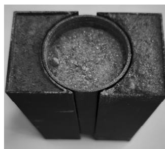
Рис. 8. Форма с образцом для КТ-исследования, компенсирующая перепад толщин. Внутри цилиндрической формы помещен образец и засыпан измельченным мусковитом. Цилиндрическая форма вращается относительно неподвижной обхватывающей конструкции
