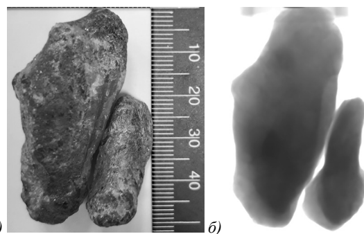
Рис. 1. Сrostок берилла с мусковитом: (а) фото образцов, (б) рентгеновское проекционное изображение
