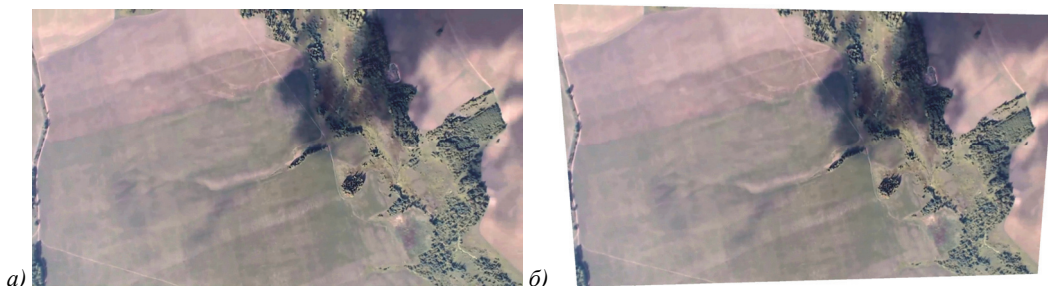
Рис. 2. Пример изображения с камеры БПЛА (а) и его нормализованный вид (б)
