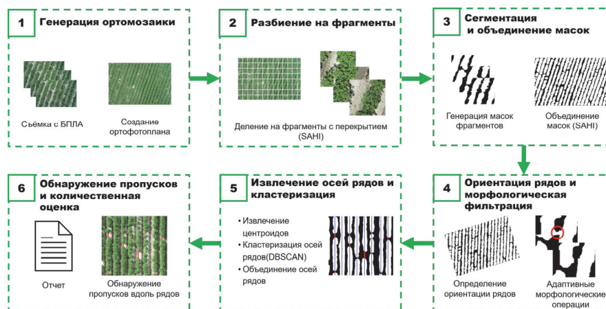
Рис. 7. Структурная схема алгоритма автоматической идентификации рядов картофеля и выявления пропусков
