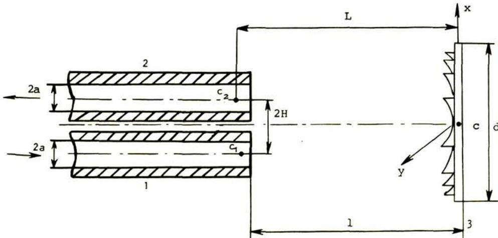
Определим высоту рельефа в зонах оптического элемента так, чтобы модовый пучок, выходящий из волокна 1 (то есть имеющий перетяжку на торце волокна), отображался в модовый пучок, входящий в волокно 2 с перетяжкой на торце.
