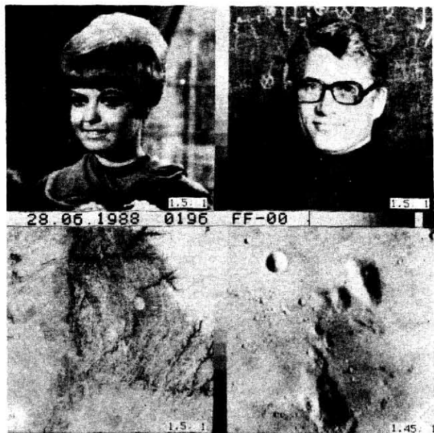
Рис. 8. Двухэтапное трансформационное кодирование с одномерным преобразованием, вариант 1
