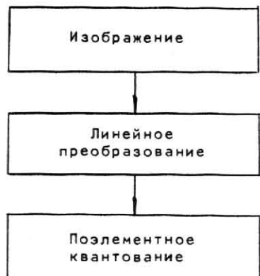
Рис. 1. Схема классического трансформационного кодирования изображений
