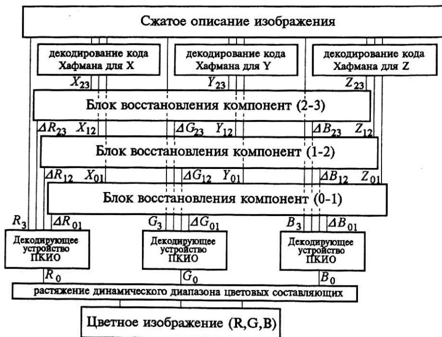
Рис. 6. Алгоритм декодирования изображения, сжатого методом ПКМО с комбинированием компонент
