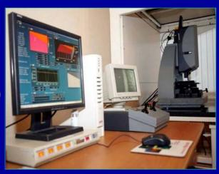
NEWVIEW 5000 обеспечивает контроль микрорельефа на участках размером до 20х20см.
